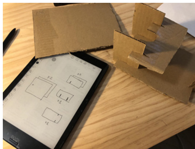
Estructura de microscopio cortada a mano de cartón de 2mm basada en los archivos de corte láser. Hamilton Mestizo. Licencia: CC BY-SA 4.0
